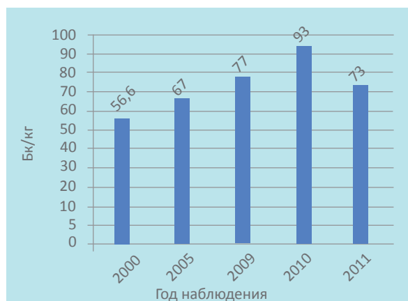
Рисунок 2.10.5 — Удельная эффективная активность природных радионуклидов в строительных материалах
